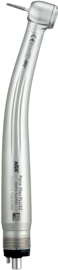
Cabezal Estándar Velocidad : 340.000-410.000 min -1 Tamaño del Cabezal : ø12,1 x Al 13,3 mm
